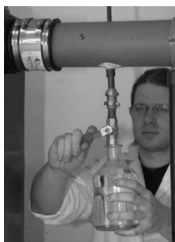
Základní zkouška: ověření výkonu odlučovače ropných látek.
